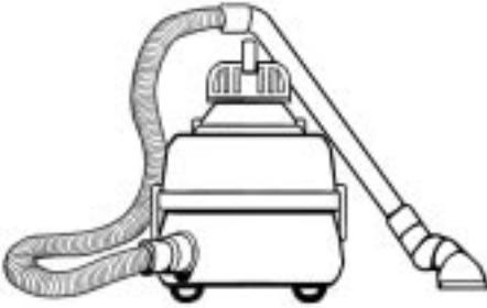
**El Sistema de Aspiración HEPA.** Para limpiar después de un trabajo con plomo que produce mucho polvo, utilice una aspiradora especial llamada HEPA. HEPA (*High Efficiency Particulate Air*) significa Sistema de Aspiración de Partículas de Aire de Alta Eficiencia.
